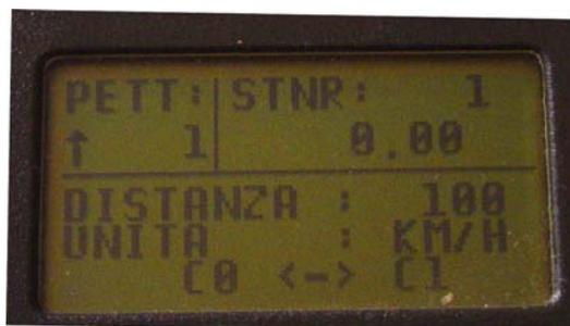
Se la fotocellula in partenza invia un impulso, il display mostrerà al posto dello "0.00" una linea tratteggiata. Il Timy calcolerà, in base alla distanza ed alla velocità minima impostate, il tempo massimo necessario per un ciclo. Se in questo tempo si avrà il secondo impulso, il display mostrerà "0.00" e sarà pronto per la prossima misurazione, e contemporaneamente, a secondo delle impostazioni, si avrà la stampa del rilevamento appena effettuato.
