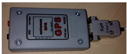
Foto 4. -1 Visualizzazione orologio sincronizzato; il GPS è privo di batterie; preleva l'alimentazione dal display (non necessita di ricarica)
