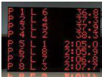
Foto 1. -1 display che visualizzano 8 righe, altezza carattere 70mm (protocollo Microgate-Microtab)
