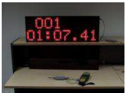
Foto 3. -1 display che visualizza pettorale e tempo gara con collegamento radio con crono Timy (protocollo ALGE)
