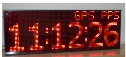
Foto 3. -1 display che visualizza pettorale e tempo gara con collegamento radio con crono Timy (protocollo ALGE)
